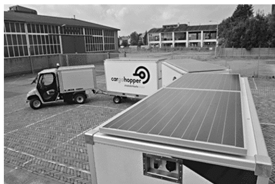
zonnepanelen op dak van laadbakken
